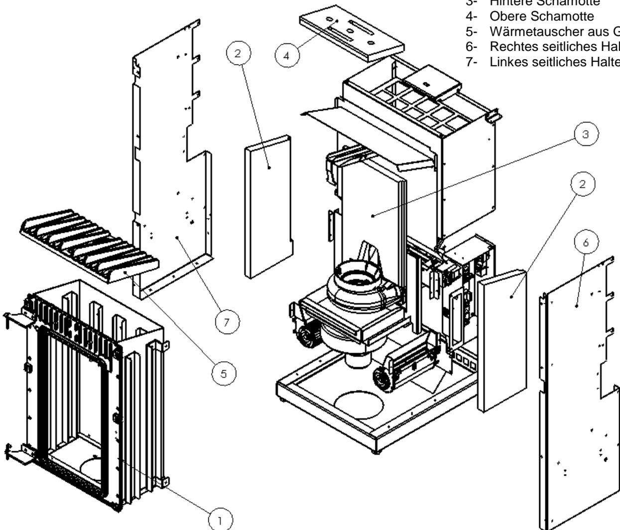
Explosionszeichnung der Brennkammer und der damit verbundenen Teile, Ofen ENERGY
