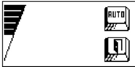
Die von der Taste
