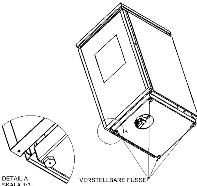
Der Ofen wird mit 4 verstellbaren Füßen geliefert, um die Aufstellung auf nicht perfekt ebenen Fußböden zu erleichtern. Um die Höhe eines Stellfußes zu regulieren, den Ofen etwas neigen und den Stellfuß wie auf der nebenstehenden Abbildung dargestellt drehen.
