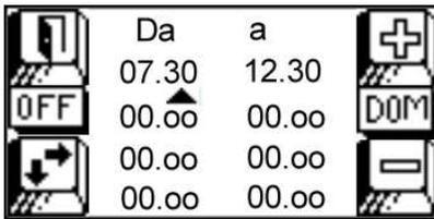
Durch Drücken auf **OFF** wird der Uhrenthermostat aktiviert, das Symbol wechselt auf **ON**, durch Drücken auf **ON** kehrt man zum Status **OFF** mit deaktiviertem Uhrenthermostat zurück.
