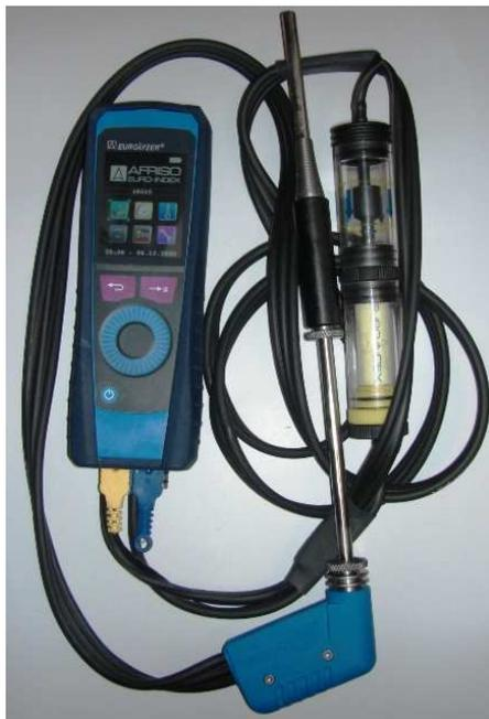
Ein Abgasmessgerät der neuesten Generation mit Mehrlochsonde(wie Abgebildet) kommt bei der Abgasmessung laut Wiener Luftreinhaltegesetz zur Anwendung. Die Preise für die Abgasmessung kosten je nach Aufwand zwischen 35 – 55 € pro Messung. Es können gegebenenfalls zusätzlich noch Anfahrtskosten entstehen. Bitte genauen Preis für Ihre Messung per Telefon oder E-Mail anfragen.
